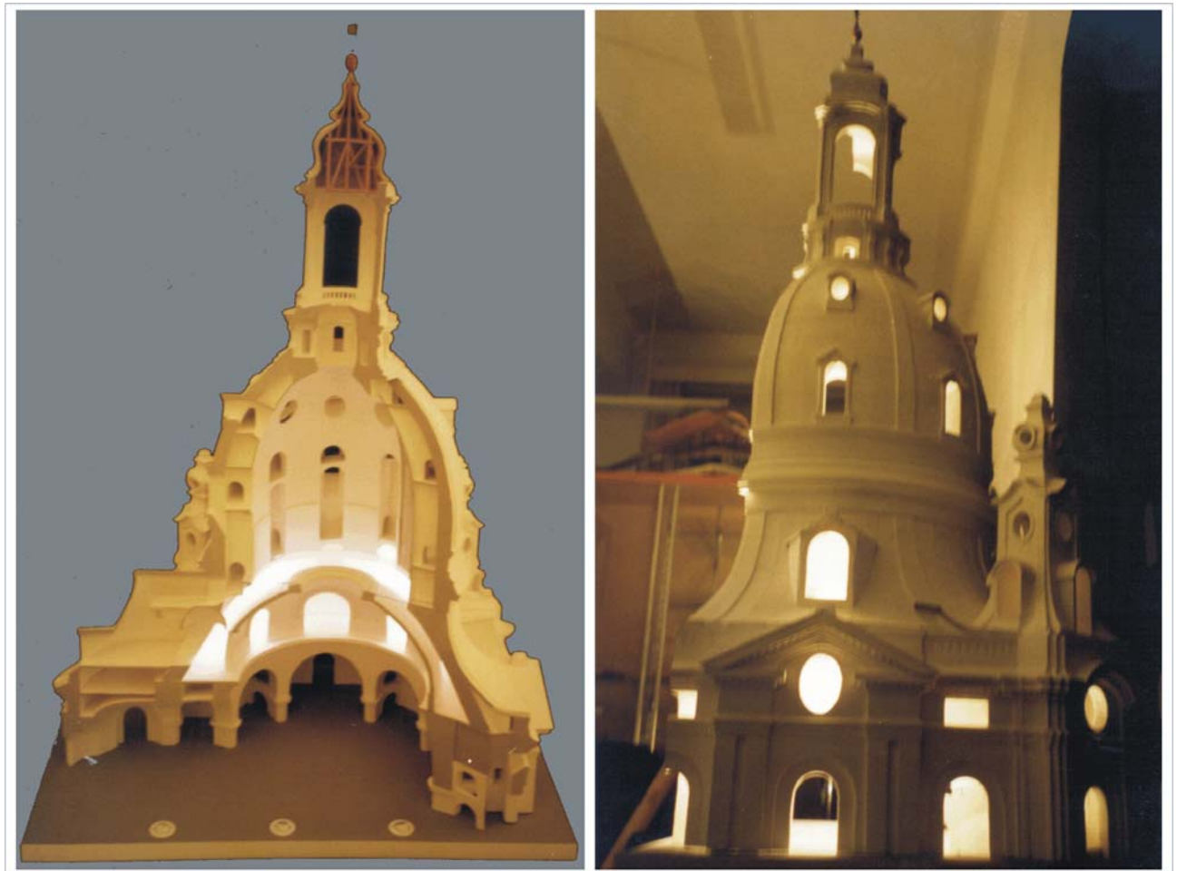
Bild 6.6.2: Die Vergegenständlichung der tragenden steinernen Glocke in einem Anschauungsmodell. „Innenansicht“ und „halbe Außenansicht“. M. 1:50. Styrodur. Modellfotos.
