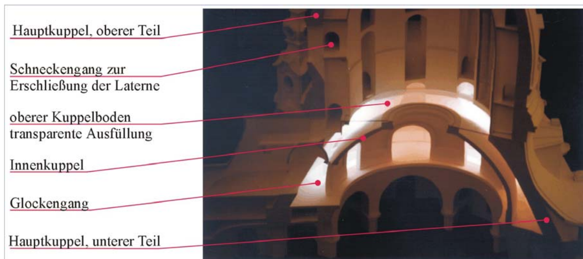
Bild 6.6.3: Das Glockengeschoß mit dem Einblick in den Glockengang. Anschauungsmodell. M. 1:50. Styrodur. Modellfoto.
