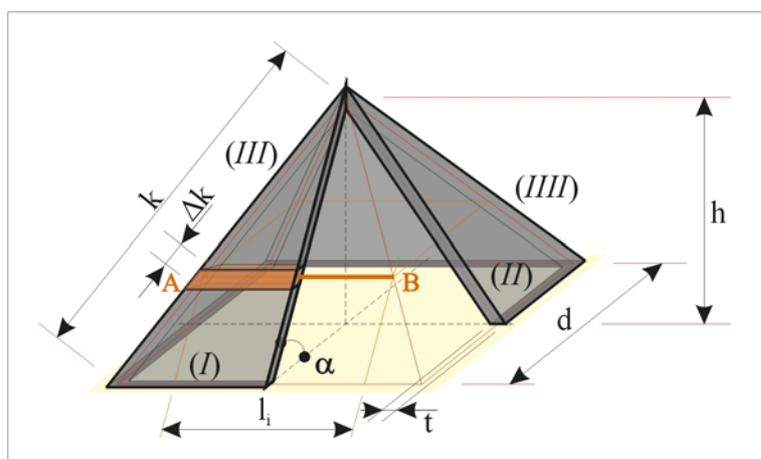
Bild 2.2.2: Geometrie einer Pyramide zur Modellüberlegung zu dem Prinzip der pyramidalen Lastabtragung.
