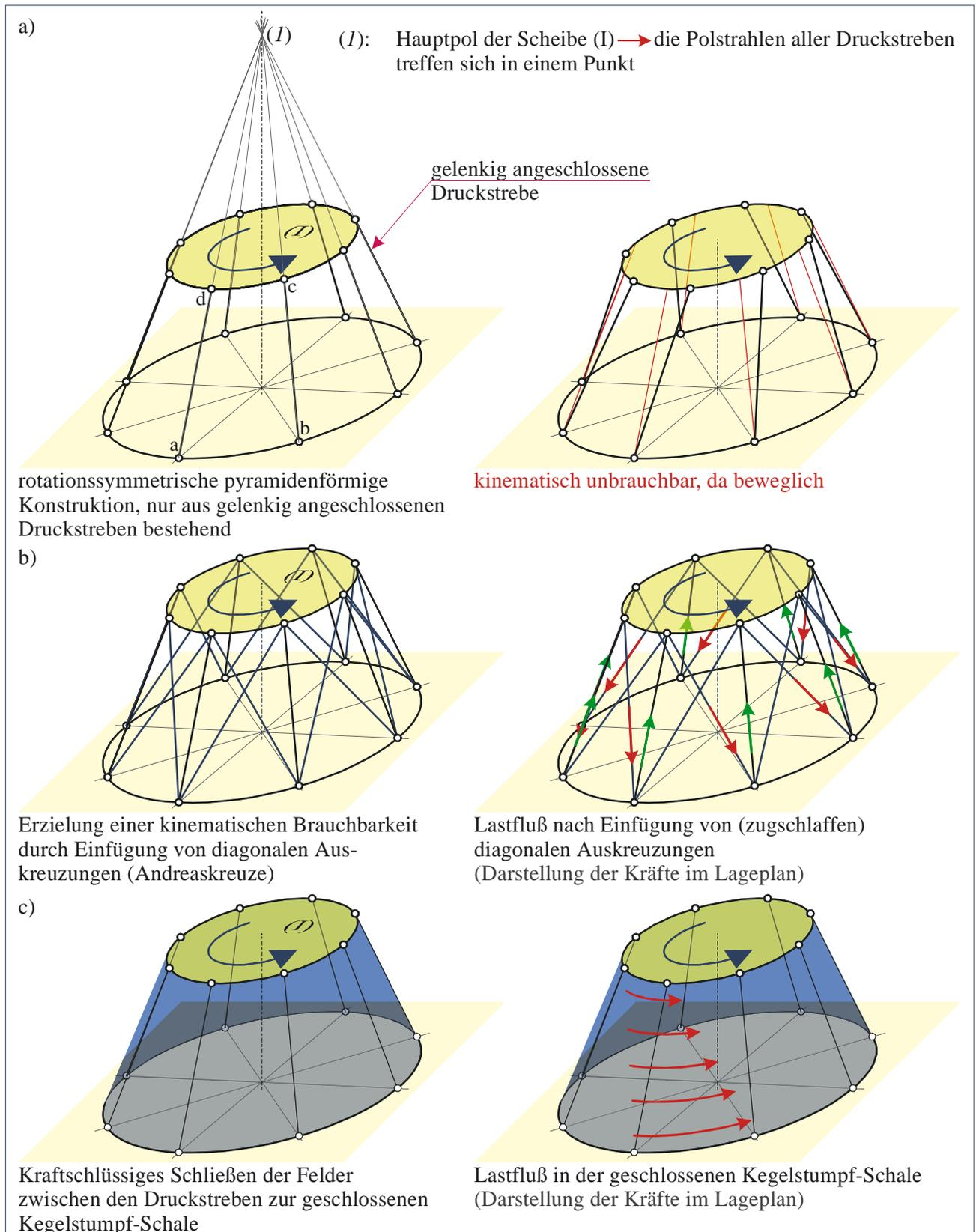
Bild 2.2.5: Abtrag horizontaler Lasten an einer Pyramide (Kegelstumpf).
