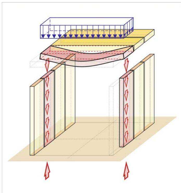
Bild 2.2.1: Prinzip der perpendicularen Lastabtragung.
