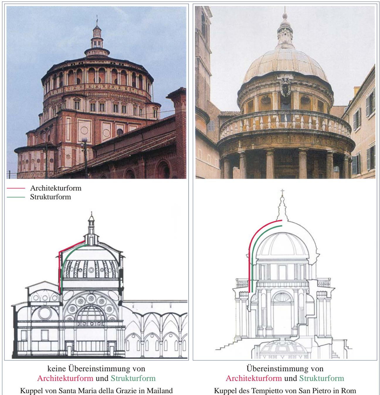
Bild 2.1.2: Veranschaulichung der Korrelation von (äußerer) Architekturform (AF) und Strukturform (SF) anhand von ausgewählten Kuppelbauwerken.<sup>11</sup>
